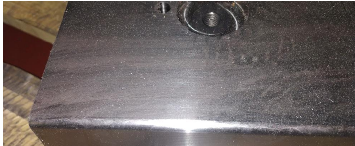
Fig. 8. Taco mecanizado hasta espesor efectivo de 1,5 mm.
